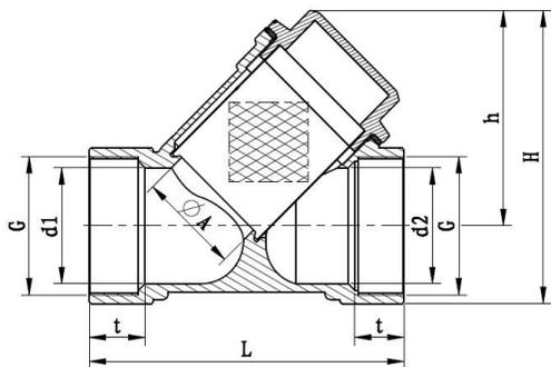
Рис 2. Габаритные размеры
