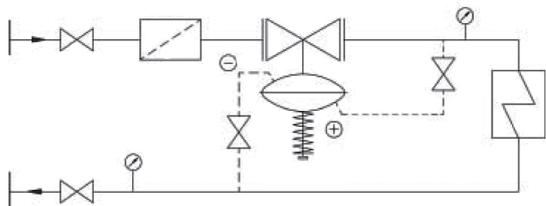
Рис. 2 Установка регулятора перепада давления на обратном трубопроводе
