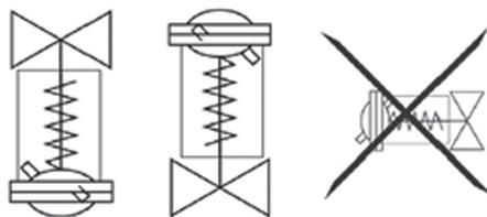
Монтажные положения регулятора на трубопроводе при температуре среды **до 100 °С**.
