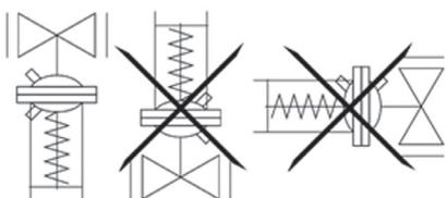
Монтажные положения регулятора на трубопроводе при температуре среды **свыше 100 °С**. Прямолинейные участки до и после регулятора не требуются.
