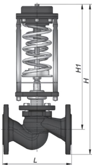
**Применение:** регулятор давления "до себя" предназначен для автоматического поддержания установленного давления рабочей среды в трубопроводе до регулятора (по ходу движения рабочей среды). Клапан регулятора при отсутствии давления нормально закрыт. При повышении давления до регулятора, клапан открывается.
