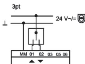
2-х / 3-х позиционном режиме управления с использованием сигнала обратной связи
