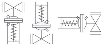
Монтажные положения регулятора на трубопроводе при температуре среды **до 100 °С**. Прямолинейные участки до и после регулятора не требуются.
