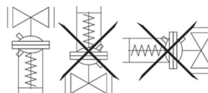
Монтажные положения регулятора на трубопроводе при температуре среды **свыше 100 °C**.
