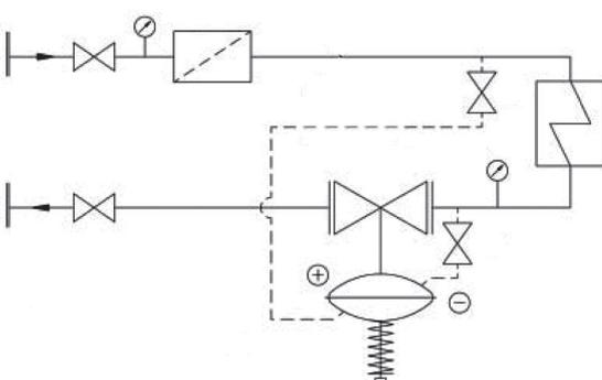
**Применение:** Применяются в системах с холодной или горячей водой и предназначены для регулирования и поддержания перепада давления в системе, а также устранения шума на регулирующем клапане в целях повышения качества регулирования и срока службы.
