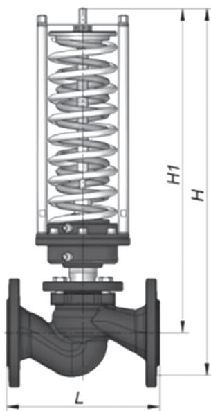
**Применение:** регулятор давления "после себя" (редукционный клапан) предназначен для автоматического снижения и поддержания установленного давления после клапана (перед объектом), путем изменения расхода теплой и горячей воды, этилен- и пропиленгликоля (до 65%).
