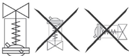
Монтажные положения регулятора на трубопроводе при температуре среды **свыше 100 °С**.
