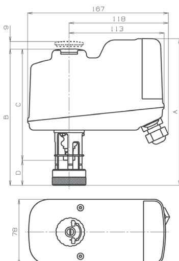
**Применение:** электроприводы VB-32 и VBA-32 предназначены для использования совместно с регулирующими клапанами M1F-FD, M1F-SFD до DN 50. Применяются в системах отопления, теплоснабжения, охлаждения, вентиляции, в производственных технологических процессах.
