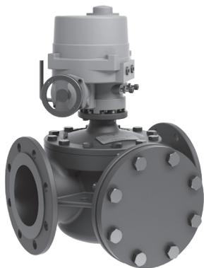
**Применение:** предназначены для регулирования расхода горячей и холодной воды, гликолевых растворов (до 50%) в системах тепло- и холодоснабжения, а также смазочного масла и других агрессивных сред (кислот, щелочей) в промышленности, применяются с электроприводом VB-300.
