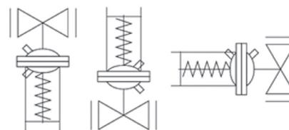
Монтажные положения регулятора на трубопроводе при температуре среды **до 100 °C**.
