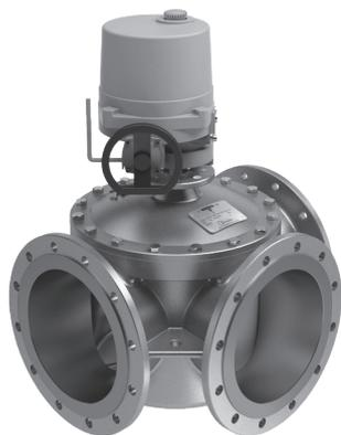
**Применение:** предназначены для регулирования расхода горячей и холодной воды, гликолевых растворов (до 50%) в системах тепло- и холодоснабжения, а также смазочного масла и других агрессивных сред (кислот, щелочей) в промышленности путем смешения и разделения потоков, применяются с электроприводом VB-300.
