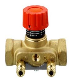
Клапан балансировочный типа CNT (далее – клапан типа CNT) служит для: перекрытия потока перемещаемой по трубопроводу среды, ограничения максимального расхода теплоносителя, проходящего через регулируемый участок системы, путем изменения пропускной способности клапана за счет ограничения степени его открытия (величины подъема штока), измерения количества теплоносителя, протекающего через данный участок системы, и присоединения импульсной трубки от клапанов балансировочных типов ASV-P, APT.
