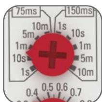
Возможность регулировки предустановки интервала времени на задержку выключения режима «звезда»
