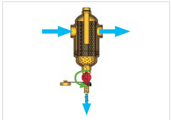
После удаления шлама закрыть сливной кран и вставить магнит обратно в контейнер, вращая его против часовой стрелки.
