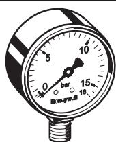
Диаметр корпуса 63 мм, резьбовой штуцер 1/4"
