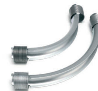
Рис. 51 Фиксаторы поворота (водоснабжение) (4 х ø) – 90° и фиксаторы поворота (водоснабжение / отопление) (5 х ø) – 90° для изгиба труб ø 32
