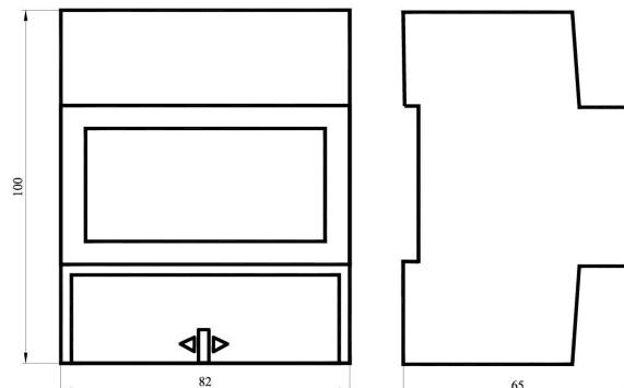
Счетчик устанавливается на DIN-рейку.
